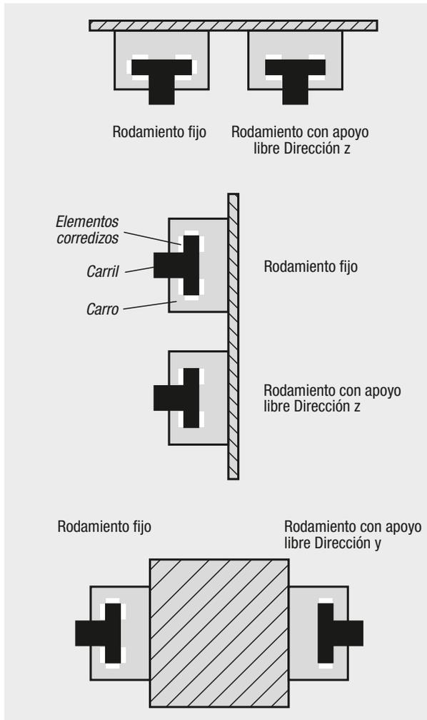
Variante de instalación horizontal con rodamiento con apoyo libre en dirección  $z$
