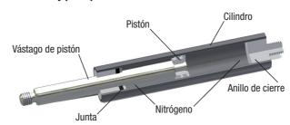
Los muelles neumáticos de presión son elementos de ajuste hidroneumáticos, cerrados sobre sí mismos y sin mantenimiento. La fuerza del muelle F1 se obtiene a partir de la presión interna del cilindro (160 bar sin carga como máximo), generada a través del fluido de nitrógeno. En el caso de los muelles neumáticos de presión, esta presión incide en el área de sección transversal del vástago de pistón. Cuando no está cargado, el vástago de pistón siempre está extendido.
