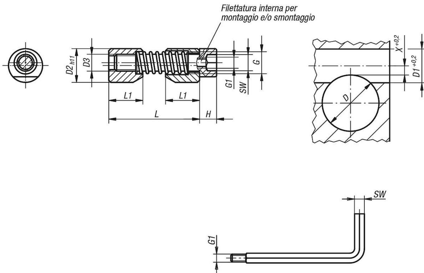
Avvitatore speciale esagonale con estremità filettata. Viene inserito nella filettatura G1 della vite a testa cilindrica per posizionare e/o rimuovere il bloccaggio per pezzi cilindrici.
