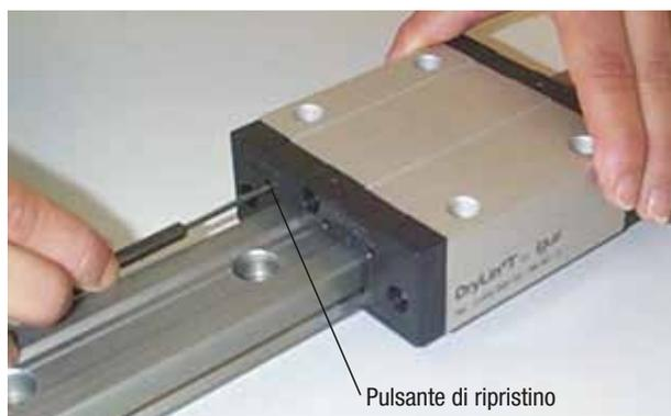
4. Qualora il gioco fosse troppo ridotto e la guida si incastrasse, non è sufficiente riposizionare la vite a esagono incassato. Dopo lo svitamento azionare anche il pulsante di reset sul lato opposto alla vite per allentare nuovamente gli elementi di scorrimento. Usare a tal fine una spina delle seguenti dimensioni:
