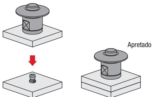
Inserire la chiusura a pressione sul bullone di fissaggio senza premere il pulsante, in tal modo la chiusura viene bloccata.
