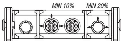
Si deve garantire uno spazio libero pari al 10% del diametro del cavo per i cavi elettrici. Si deve garantire uno spazio libero pari al 20% del diametro del cavo per le linee idrauliche.
