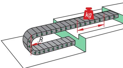
Le catene portacavi sono realizzate di serie con un precarico per raggiungere una lunghezza autoportante quanto più elevata possibile. Il precarico provoca una sovrarelevazione nel tratto superiore della lunghezza autoportante.
