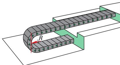
Il raggio di curvatura necessario della catena deve essere uguale o superiore al raggio minimo di curvatura più grande dei cavi da porre in opera. Attenersi alle specifiche in merito del costruttore dei cavi e dei flessibili.
