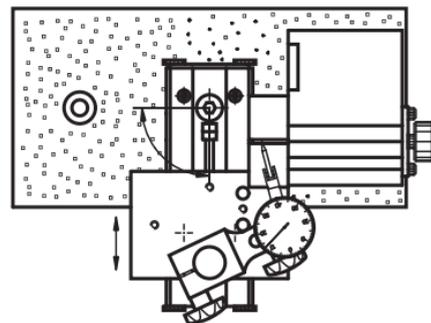
La slitta può ruotare in modo variabile di 90° consentendo così la rimozione e il posizionamento rapido al cambio del pezzo.
