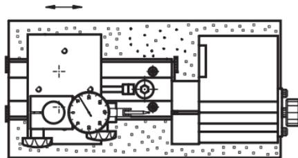
Controllo di un diametro interno
