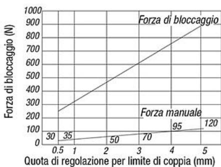
Con una forza di bloccaggio di 900 N, la quota di regolazione per il limite di coppia è di 5 mm, la forza manuale dell'impugnatura è di 120 N.
