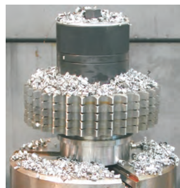
Porca de fixação para a fixação de rodas de corrente no trabalho de fresagem
