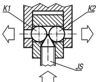
Girando el tornillos de ajuste (JS) las bolas K1 y K2 se separan y se aprietan contra la pared. Esto permite un ajuste sin juego.
