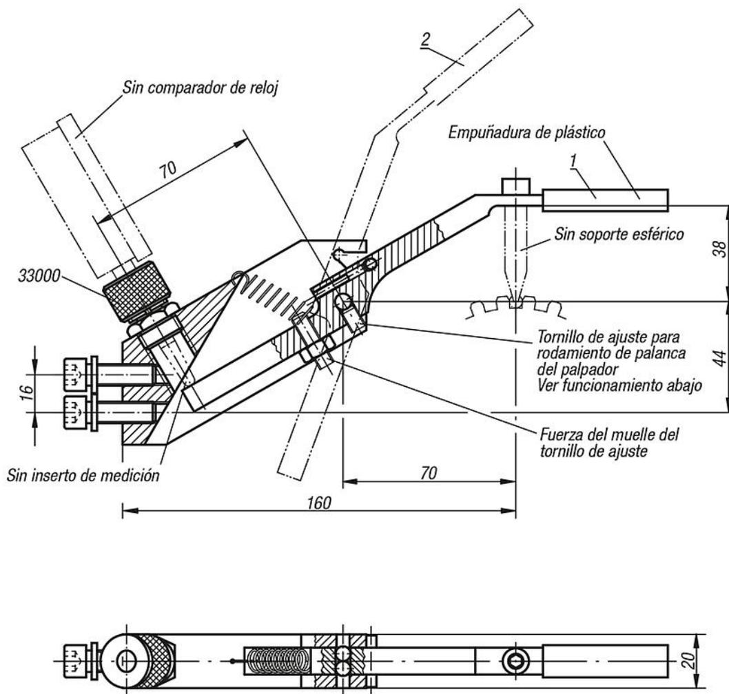
Funcionamiento del rodamiento de la palanca del palpador
