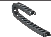
Cadenas portacables de plástico altura interior 17 mm, se abren en el radio interior
