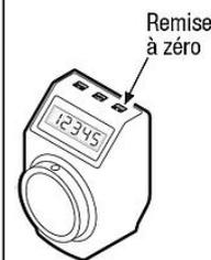
La remise à zéro peut être retardée de 5 secondes au moyen des paramètres afin d'éviter une remise à zéro par erreur.
