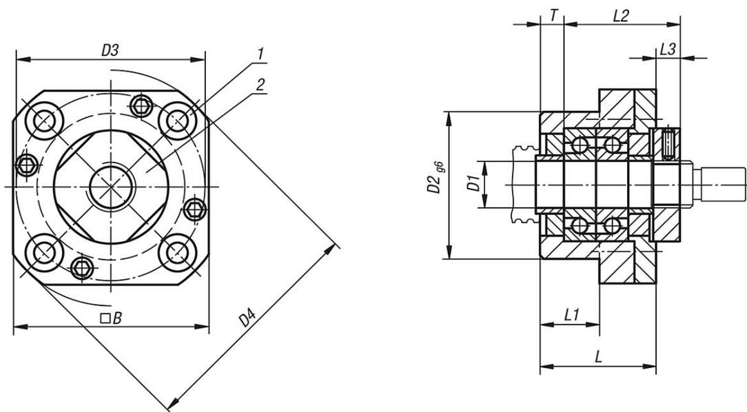
Exemple d'unités de palier fixe et mobile montées à l'extérieur
