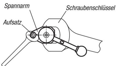
Wenn Sie einen Aufsatz auf den Spannarm montieren, sichern Sie den Spannarm mit einem Schraubenschlüssel, damit er keine Drehkraft aufnimmt.
