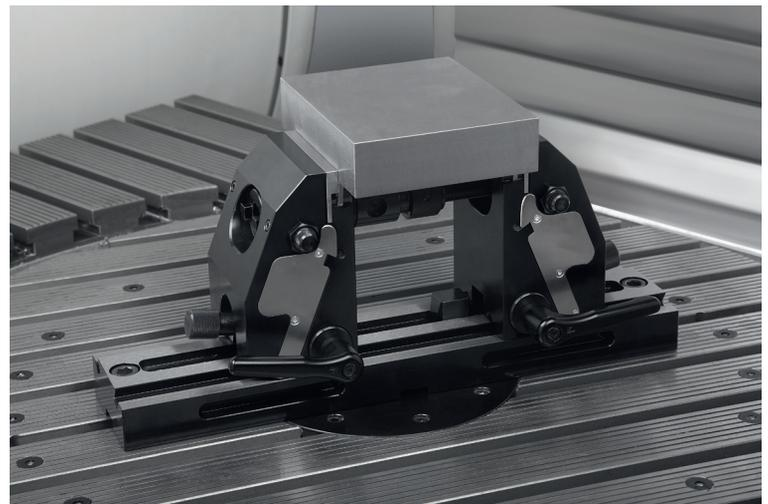
Mit den Klemmhebeln lassen sich die Spannbacken schnell lösen und spannen.
