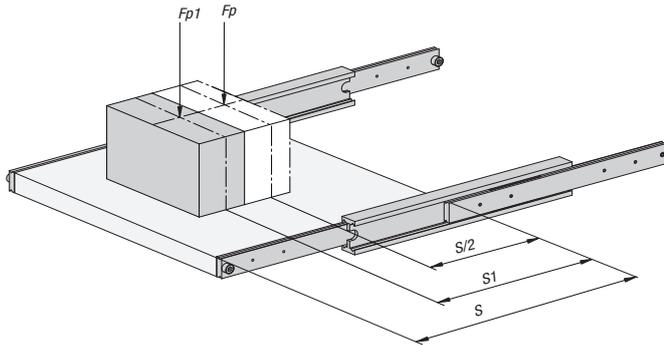
$$\text{Capacité de charge par paire } F_{p1} = \frac{0,5 \times \text{capacité de charge par paire } F_p \times \text{course } S}{\text{Course } S_1}$$
