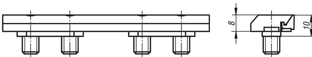
Vis à tête cylindrique DIN 6912 M8x12 8.8
