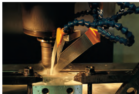
Buse plate articulée 16 trous de ø1,5
