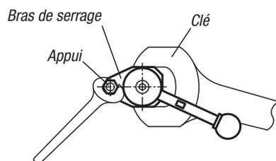
Pour monter un appui sur le bras de serrage, il faut maintenir le bras avec une clé pendant le serrage pour éviter la rotation de celui-ci.
