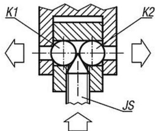
通过旋转调节螺栓 JS 使顶珠 K1 和 K2 挤向两侧。由此可进行无间隙调节。
