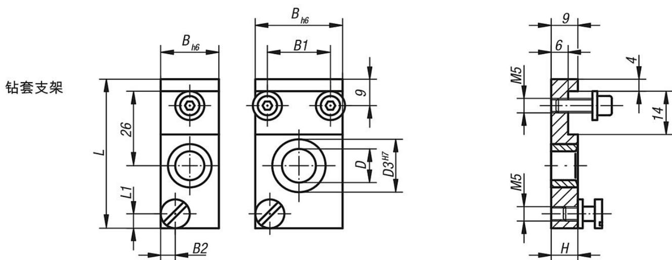
最小孔距  $L3 = \frac{1 \text{号钻套支架 (尺寸 B)} + 2 \text{号钻套支架 (尺寸 B)}}{2}$
