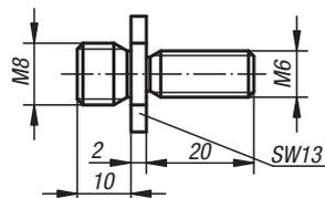
Adaptador de fijación M8/Ø8
