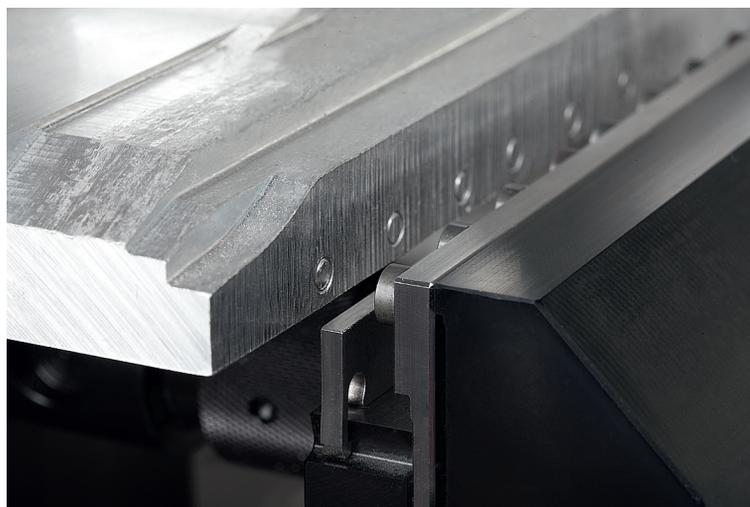
Mediante el acoplamiento para la sujeción en cruz pueden unirse entre sí dos dispositivos de sujeción de 5 ejes compactos con un desvío de 90 grados. Hay sistemas de sujeción de piezas de trabajo con dimensiones de 4 lados distintas.
