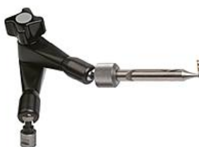
Junta articulada de fixação com fixador de peças pequenas
