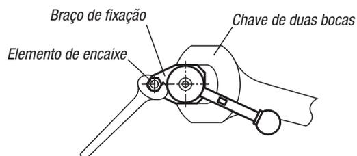
Ao encaixar uma peça no braço de fixação, trave-o utilizando uma chave de duas bocas, para que ele não sofra forças de torção.
