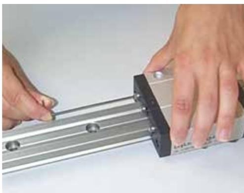
2. Reajuste com uma chave Allen a folga axial do mancal para os três pontos de guia.
