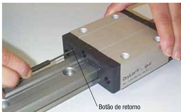
4. Caso a folga estiver muito estreita e os carros deslizadores estiverem bloqueados, não basta apenas voltar o parafuso Allen para a posição anterior. Após desparafusar o parafuso, acione adicionalmente o botão de retorno posicionado no lado oposto ao parafuso, para soltar novamente os elementos deslizadores. Para isso, utilize um pino do seguinte tamanho:
