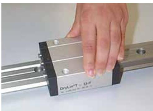
3. Após fazer o ajuste, verifique a folga dos carros deslizantes. Se ela for suficiente, aperte em seguida as contraporcas firmemente e coloque as capas de proteção.
