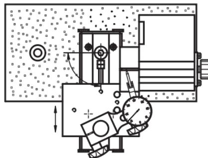
O deslizador de guia apresenta deslocamento variável e pode virar a 90°, possibilitando assim movimentação e posicionamento rápidos durante a troca de peças.
