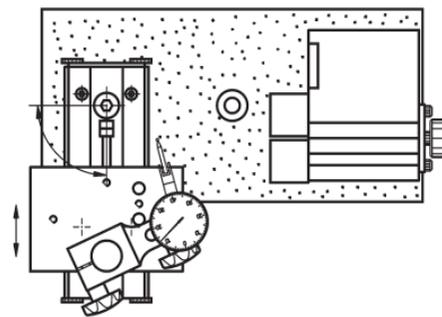
A regulagem do deslizador de guia pode ser feita por meio de um parafuso. Ambos os furos de posicionamento permitem a obtenção de uma área de trabalho mais ampliada.
