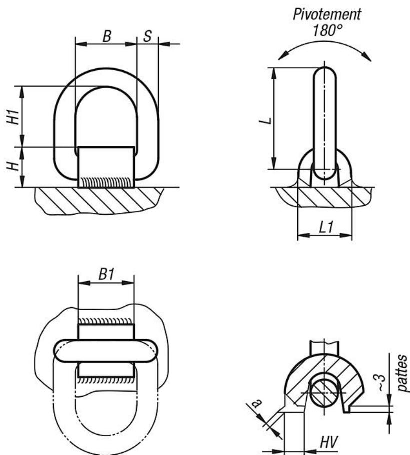
Charge maximale « G » en kg en fonction de la configuration
