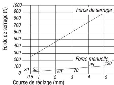
Pour une force de serrage de 900 N la course de réglage est de 5 mm, la force manuelle sur la poignée est de 120 N.
