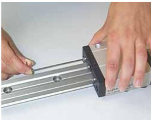
2. Corrigez le jeu du palier pour les 3 points de guidage à l'aide d'une clé mâle coudée pour vis à six pans creux.
